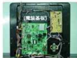
冷蔵庫背面にある電装 Box 内の電装基板 (緑色の部分) ははんだに無鉛はんだを採用。
